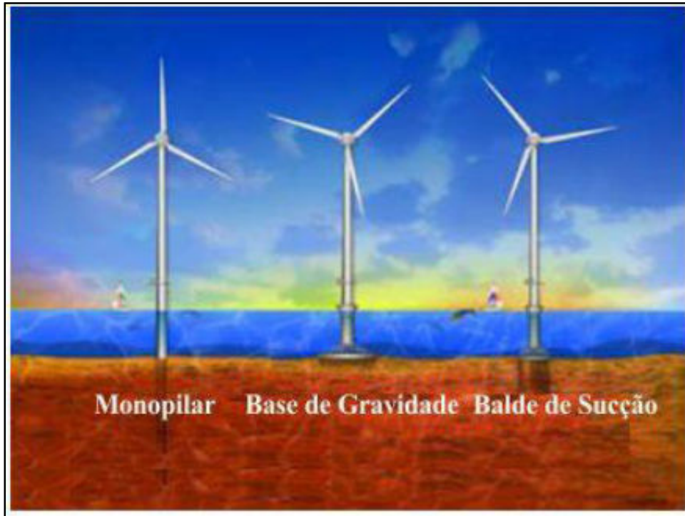
Figura 16 – Tipos de fundações para águas rasas Fonte: MUSICAL, 2006.
