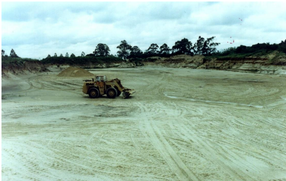
Foto 01 – Área de lavra superficial (raspagem) com uso de pá carregadeira.
