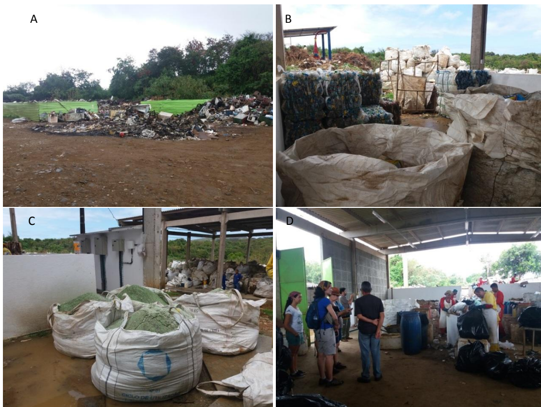
Figura 45. Registros da UTRS de Noronha: A) resíduos volumosos como cadeiras e fogões dispostos direto ao solo; B) bigbags e fardos compactados para envio ao continente; C) pequena amostra do total de garrafas de vidro trituradas; D) área de triagem dos resíduos e os trabalhadores do continente da empresa Universo.
