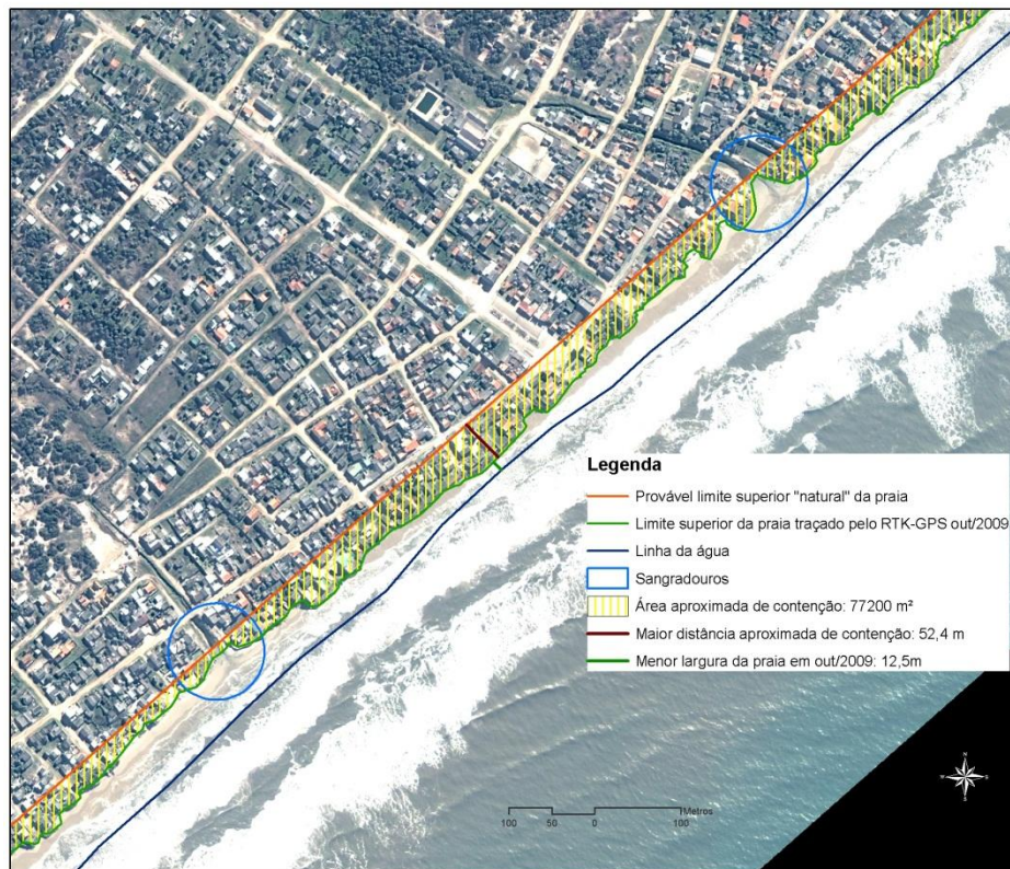
Figura 24 – Área aproximada de contenção da orla do balneário do Hermenegildo comparado à base das dunas frontais adjacentes (provável limite superior natural da praia, linha laranja). Nos círculos azuis é possível perceber como os sangradouros tendem a acompanhar a evolução natural da praia. Extraído de Koerner (2009).
