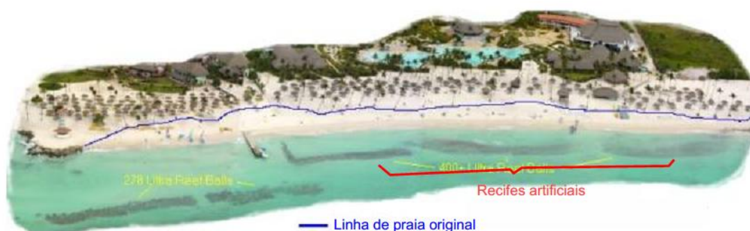
Figura 9 - Exemplo de engordamento de praia causado pela atenuação de ondas em recifes artificiais utilizados como quebra-mares submersos. Projeto realizado em praia da República Dominicana (Fonte: http://www.artificialreefs.org/ScientificReports/DRmemo.htm )
