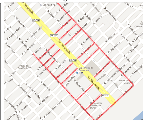
Figuras 4a e 4b: Planta e área de abrangência da rede de esgoto do Cassino.
